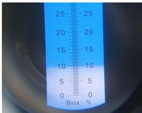
Gambar 2 Hasil pembacaan pada refraktormeter
