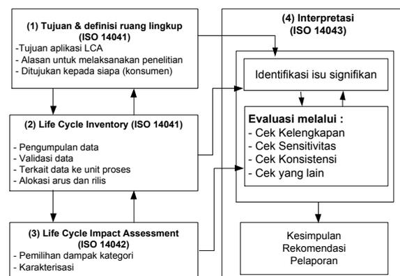
Gambar 1. Tahapan LCA
