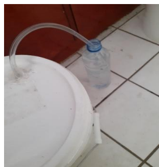
Gambar 2. Tutup yang tersambung dengan selang dan air pada botol
