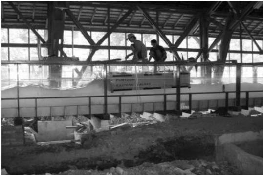
Gambar 12. Pemecah gelombang terapung yang diuji dalam saluran gelombang (Ajiwibowo *et al.*, 2009).
