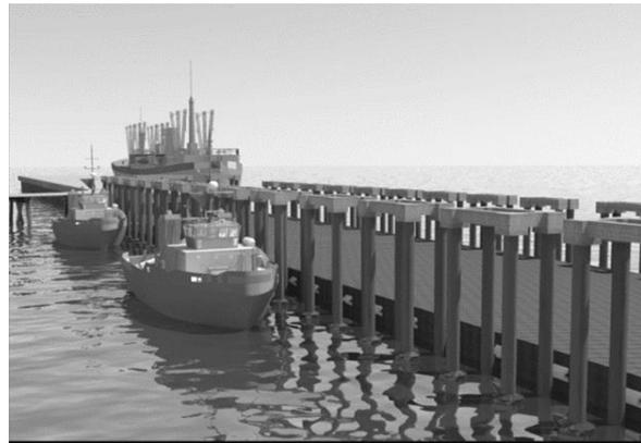
Gambar 5. Visualisasi *breakwater* yang dimaksud. *Breakwater* terapung berada pada bagian tengah dengan *frame* tiang pancang yang membatasinya agar tetap berada di tempat.
