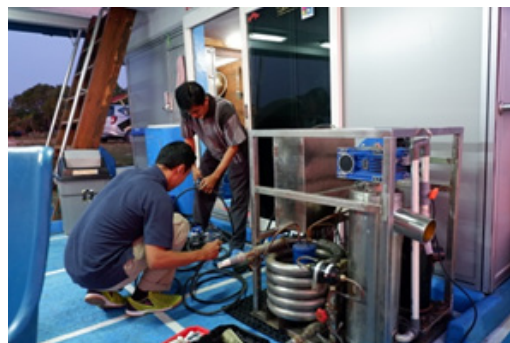
Gambar 7. Test prototipe slurry ice machine di atas kapal 35 GT di Tanjung Lesung untuk mengolah air laut menjadi bubuk es dan menggunakannya untuk mendinginkan dan menjaga kesegaran beberapa jenis ikan hasil tangkapnya
