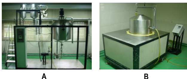
Gambar 1. Tangki netralisasi (A) dan Spinner (B) skala pilot plant
