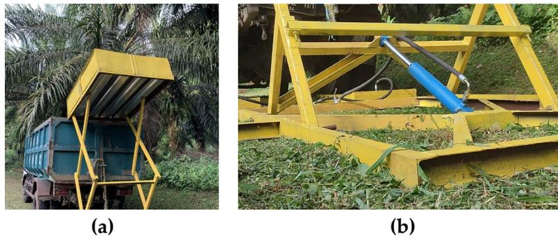
**Gambar 6.** Komponen bagian scissor lift: (a) bak TBS terangkat, (b) silinder hidrolik
