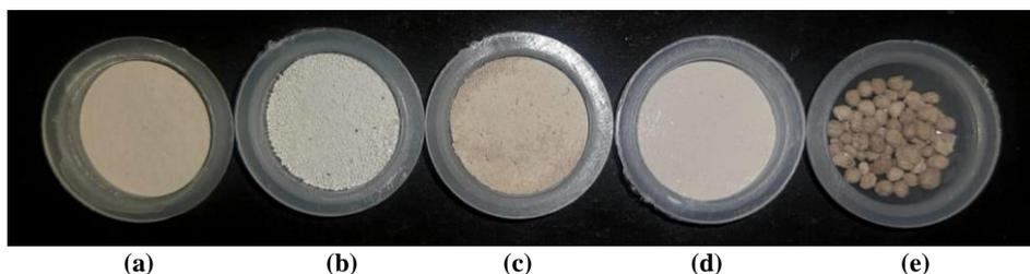
Gambar 4. Sampel (a) zeolit alam serbuk (b) geopolimer serbuk (c) komposit zeolit-geopolimer granul kecil (serbuk) (d) zeolit + geopolimer (*physical mixing*) (e) komposit zeolit-geopolimer granul besar
