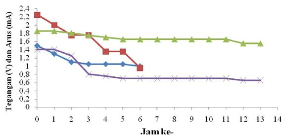
Gambar 6 Perbandingan tegangan dan arus dari baterai komersial dan baterai elektrolit polimer kitosan-PVA (—•— tegangan baterai komersial-volt, —■— arus baterai komersial-mA, —▲— tegangan baterai dengan elektrolit kitosan-PVA-volt dan —×— arus baterai dengan elektrolit kitosan-PVA-mA).
