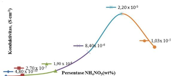
Gambar 2 Nilai konduktivitas ion elektrolit polimer *chitosan-PVA* dan kecenderungannya dengan peningkatan persentase amonium nitrat ( $\text{NH}_4\text{NO}_3$ ), —●— 0 wt%, —■— 5 wt%, —▲— 15 wt%, —◆— 25 wt%, —\*— 35 wt%, dan —○— 45 wt%
