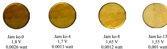
Gambar 8 Perubahan warna baterai dengan elektrolit polimer kitosan-PVA setelah pemakaian.
