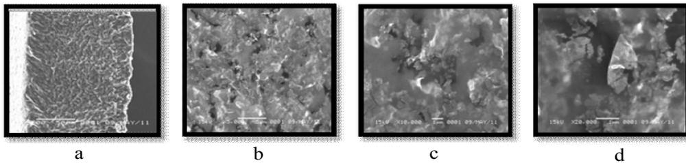
Gambar 3 SEM elektrolit polimer dengan bahan dasar *chitosan-PVA* dengan penambahan garam amonium nitrat terbaik ( $\text{NH}_4\text{NO}_3$  35wt%) pada perbesaran a) 500x, b) 5000x, c) 10.000x, dan d) 20.000x.
