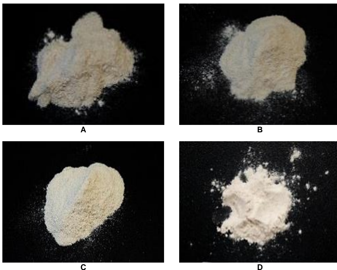
Keterangan: tepung rumput laut dengan bahan pemucat CaO 0,125% (A); CaO 0,25% (B); CaO 0,375% (C); CaO 0,5% (D)
