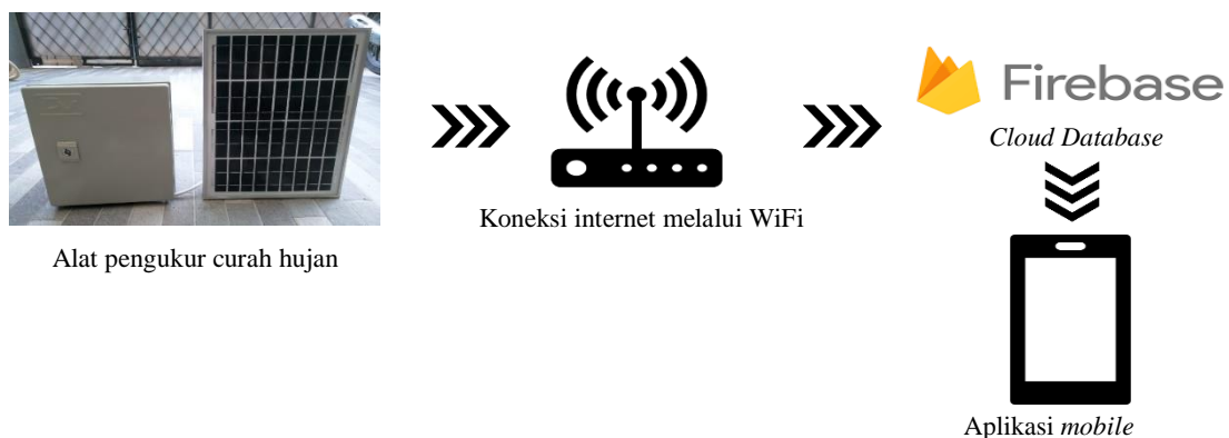
Gambar 4 Arsitektur umum sistem pengukur curah hujan berbasis IoT.
