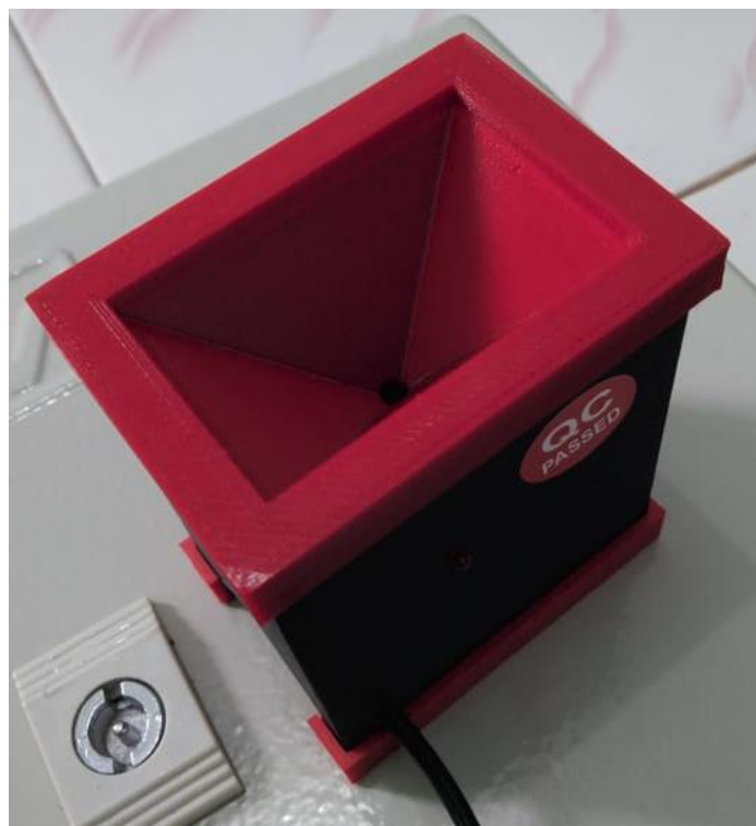
Gambar 2 Tampak luar sensor curah hujan jenis tipping bucket .
