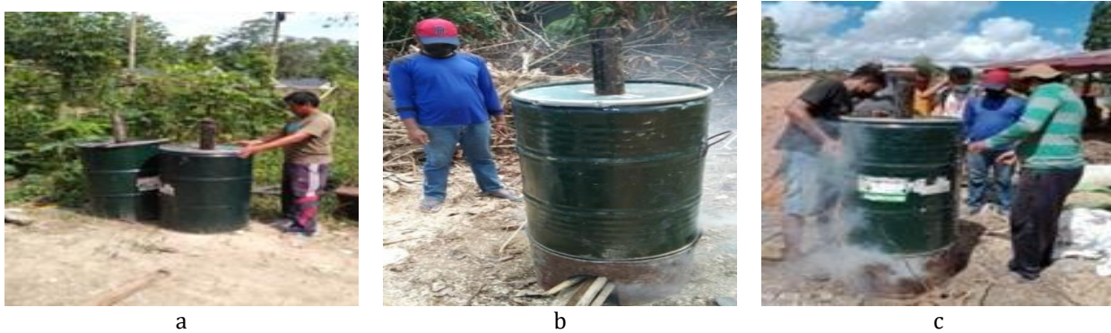
Gambar 4 a) Pembuatan pirolisator dari drum bekas untuk memproduksi biochar; b) Salah satu anggota KT mendemonstrasikan pembuatan biochar limbah pembuatan mebel; dan c) Tim PKM bersama petani mitra mendemonstrasikan pembuatan biochar menggunakan pirolisator produk anggota KT.
