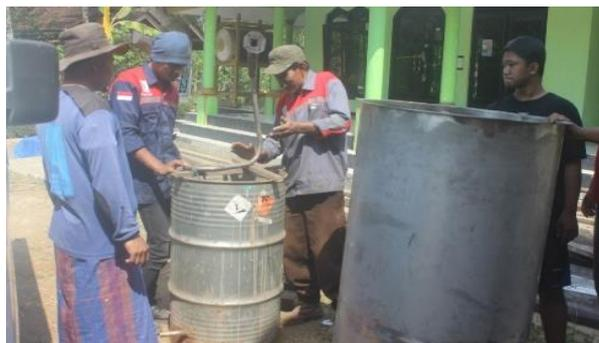
Gambar 5 Perakitan instalasi pembuatan asap cair dari tempurung kelapa.
