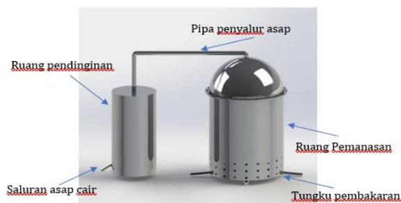
Gambar 4 Desain instalasi pembuatan asap cair.
